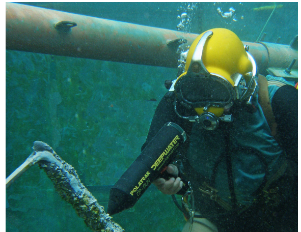
方便潜水员操作 自含式读出装置无需潜水脐带绳调节。
