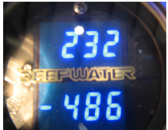
易于读取 高亮度 LED 读出装置方便潜水员在低能见度情况下使用。
