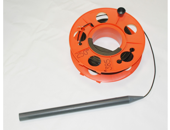
标配 250 英尺缆绳卷盘 DC II 是同类产品中唯一一个双元件便携式参考电极。
