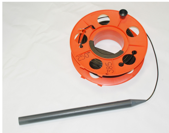
Vém de fábrica com carretel com cabo de 76 m (250 pés)
