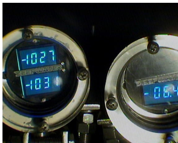
Le Deep C Meter in situ installé sur un ROV La sonde ROV II effectue une lecture.
