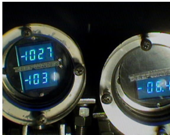
Il Deep C Meter in situ montato su un ROV La sonda ROV II sta prendendo un valore di prova.
