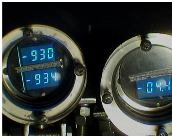
El Deep C Meter en su lugar montado en un ROV
