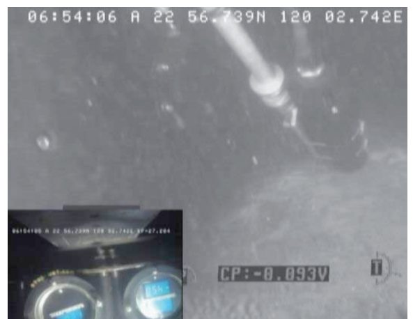
水下拍照 使用 Deep C Meter 双读出装置在 CP 勘测过程中进行水下拍照。
