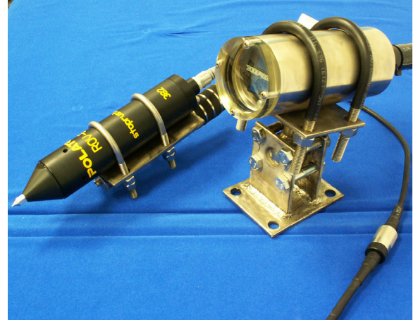
Deep C Meter 与 ROV II CP 探测仪连接并安装在 ROV 活动托架上。
