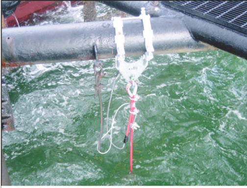
خطاف للمقاومة تم تثبيت RetroLink في الموقع بخطاف للمقاومة.
