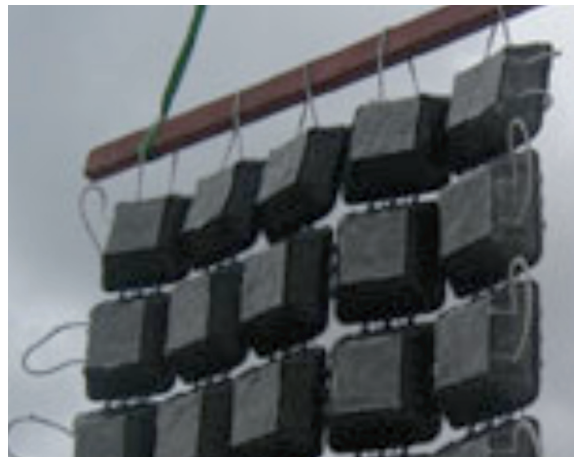
RetroMat 铝阳极浇筑在选定的混凝土砌块内。 垫层的钢丝绳心提供低电阻的阳极阵列。
