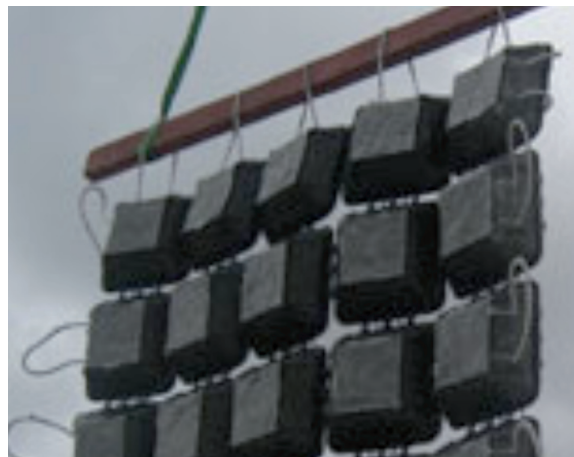
RetroMat- Ânodos de alumínio são fundidos no interior de segmentos selecionados de concreto. O núcleo do cabo de aço do tapete proporciona uma matriz anódica de baixa resistência.
