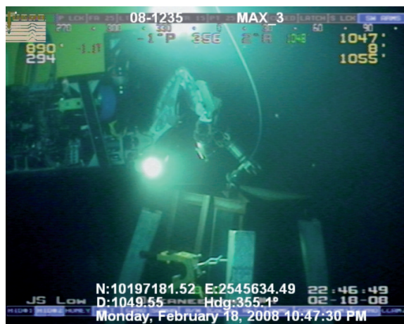
Instalação do RetroPod ROVs colocam um coxim em águas profundas e instalam RetroClamps.
