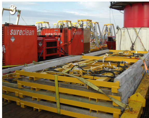
Mer du Nord RetroSled sur un navire prêt à moderniser les conduites d'écoulement de Forties
