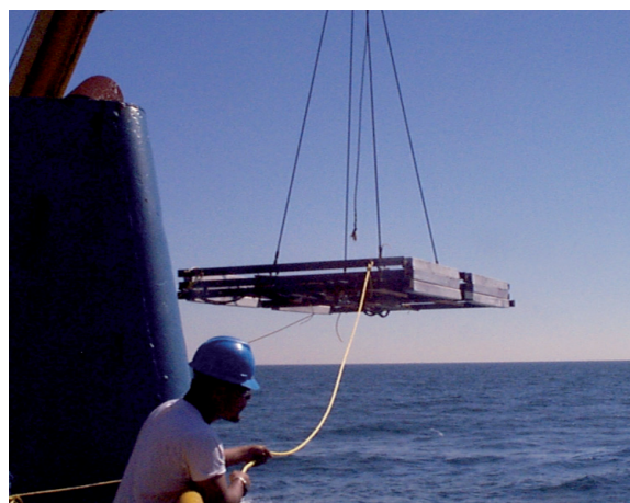
Guinée équatoriale La taille du traîneau expansible déployé est de 3,6 m x 2,4 m et mesure 12 m au fond.
