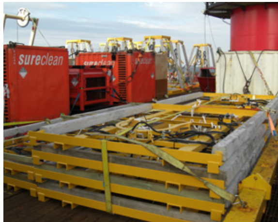
Mare del Nord RetroSled a bordo di imbarcazione per il retrofit di linee di flusso nel campo di Forties.
