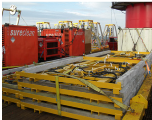
Mar do Norte RetroSled a bordo de uma embarcação para adaptar as linhas de fluxo internas do Forties.
