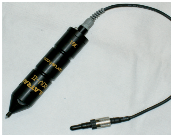
ROV-II 及连接器 图示为 ROV II 及连接潜水员脐带管或 Deep C Meter 用的连接器（整套 ROV 读出装置）。
